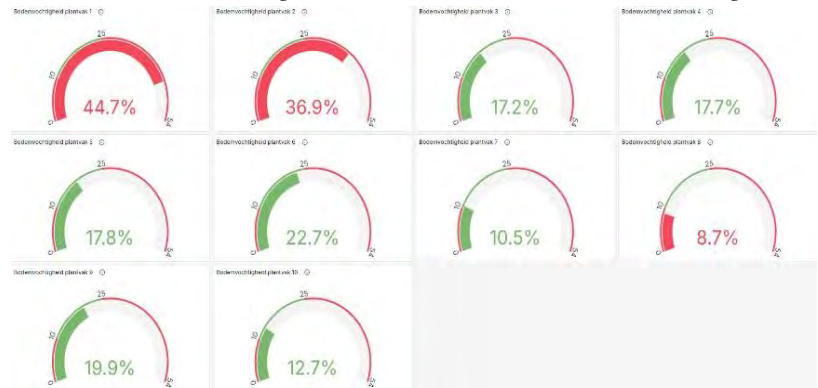
Afbeelding 3: Tem bodemvochtsensoren die de meest recente bodemvochtwaarden weergeven, verdeeld over het Yuverta trainingsdak.
